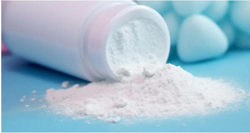
滑石粉被认为是一种无机聚合物，基于两种基本的“单体”结构-硅四面体和镁八面体-因为它包含一个连续的八面体层连接在三角形边的八面体。这种独特的结构使滑石粉成为加强造纸过程和生产新的纸张涂层的良好候选者，同时为不同用途的纸张增加了新的，独特的和增强的特性<sup>10</sup>。然而，滑石粉在造纸工业中的主要缺陷是它的颗粒之间会发生凝聚。
